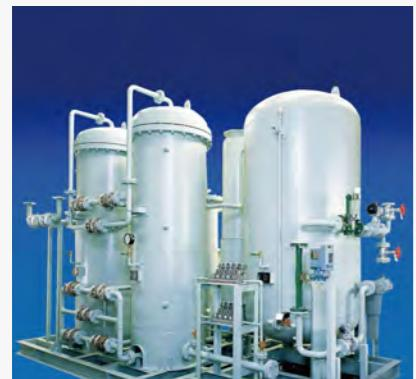
KURASEP™是采用了可乐丽化学公司开发研制的高性能吸附剂分子筛活性炭，以PSA方式工作的氮气分离装置。
